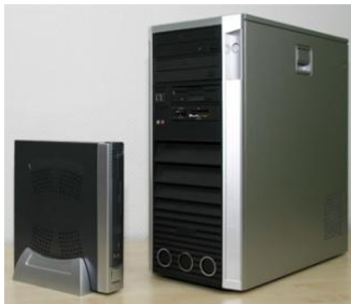
Abbildung 7-21: Vergleich eines Thin-Clients (ca. 0,9 kg) mit einem herkömmlichen Desktop PC (ca. 8,5 kg)
