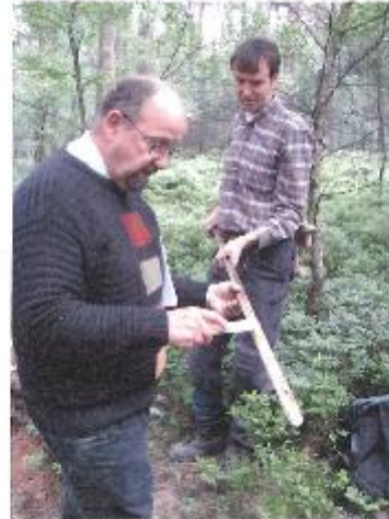
Mitarbeiter des Geologischen Dienstes beurteilen die Bodenigenschaften an Bohrstück
