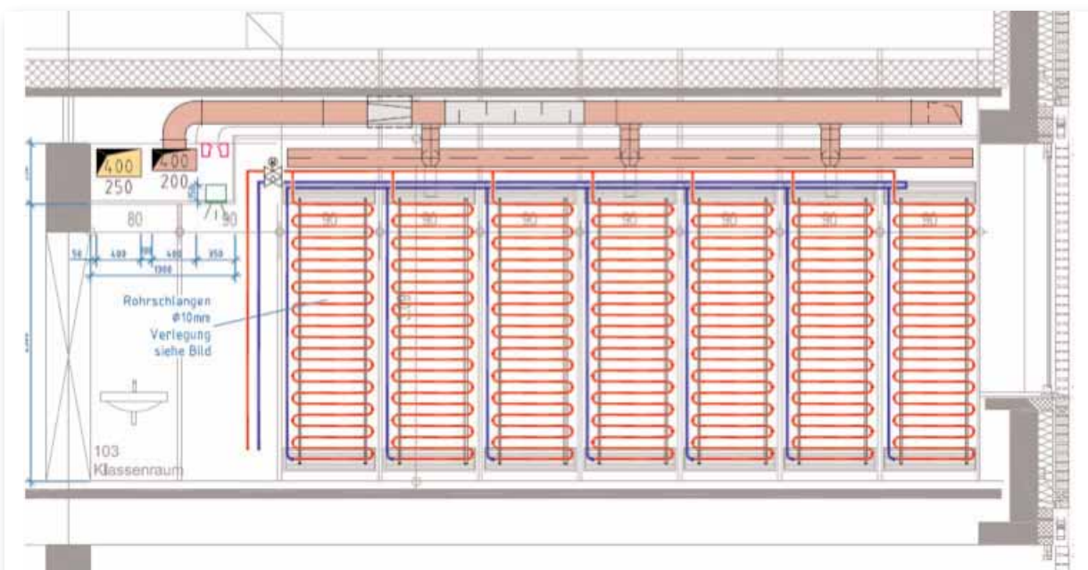
Abb. 8-5: Detailzeichnung der Klimawand
