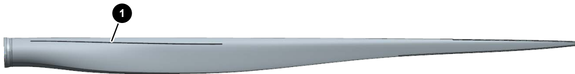
Abb. 7: Position der Vortexgeneratoren an der Saugseite
