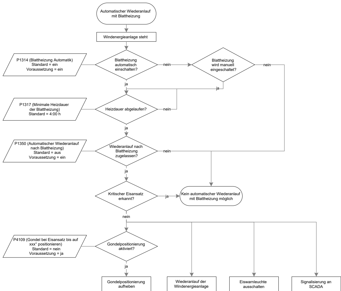
Abb. 3: Automatischer Wiederanlauf mit Blattheizung
